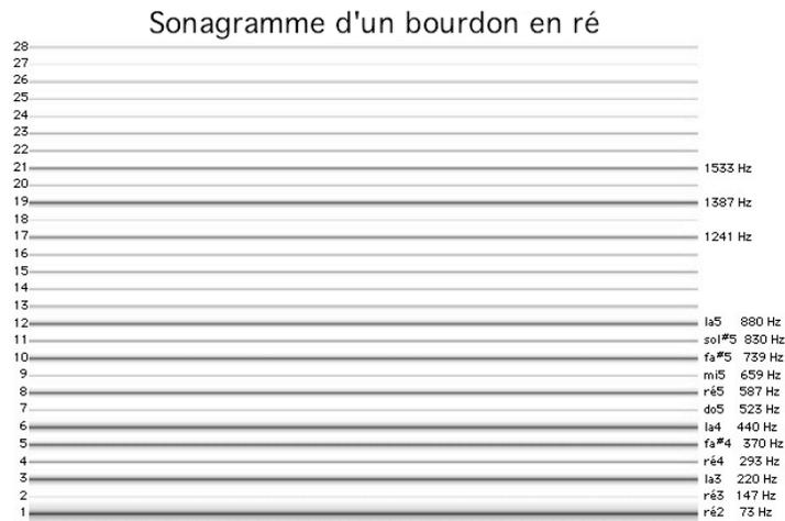
FIG. 2.3 – Sur l'analyse spectrographique d'un échantillon de bourdon en ré, on constate que les lignes les plus foncées, correspondant aux harmoniques qui possèdent le plus d'énergie, coïncident avec les modes de résonance du tuyau (voir Fig. 2.2).
